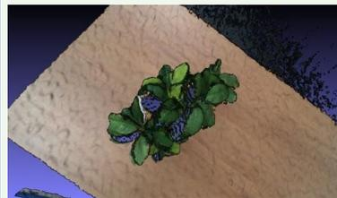
私は、植物の点群データから葉面積を推定する研究を行っています。研究内容は、rgbd-カメラという特殊なカメラを使い、植物の点群データを取得します。取得した点群データから植物の部分の点群を抽出し、植物の3Dモデルを作成します。作成した3Dモデルから面積の計算を行い葉面積の推定を行うというのをやっています。
